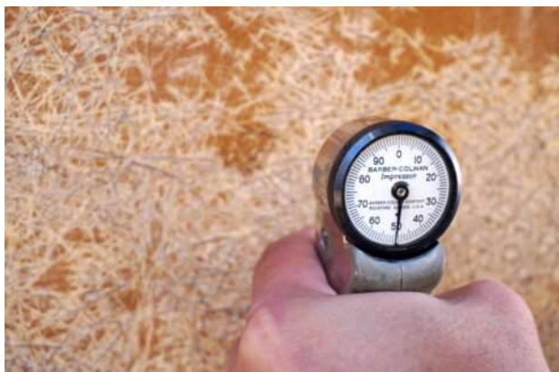
バーコル計による硬度測定
