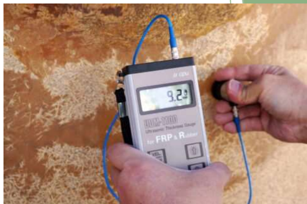
FRP膜厚計による膜厚測定
