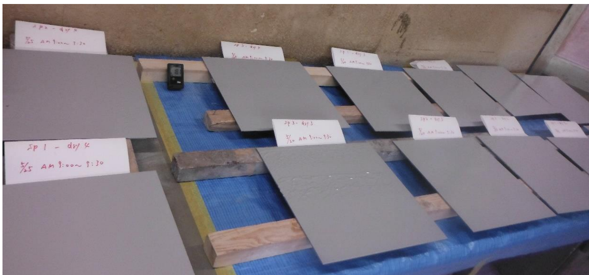
図 ゲルコート塗布後の外観写真
