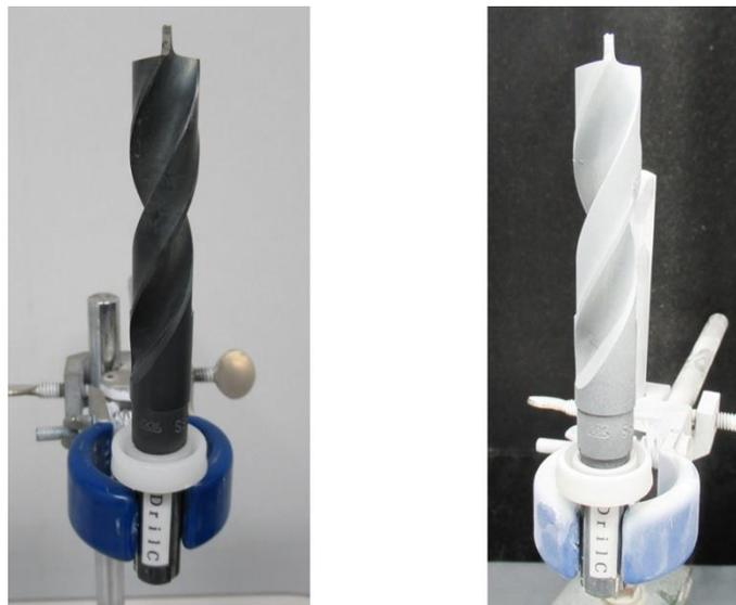
図 塗装前 (左) と塗装後 (右) の Drill
