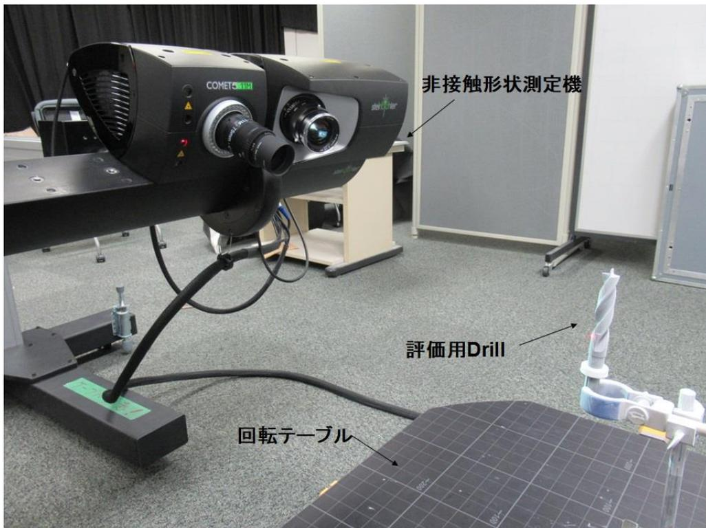
図 評価用 Drill の形状測定の様子
