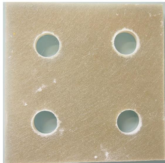
図 加工後の FRP 平板（左：表面 右：裏面）
