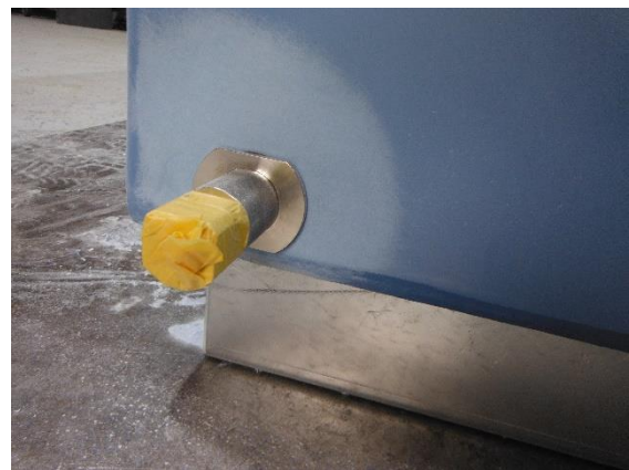
工程3: 吐水機構設置 (左下: 内面写真 右下: 外面写真)
