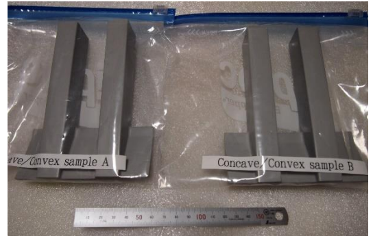
図 凹凸形状を有する成形物外観写真 (左:新工法 右:一般工法)
